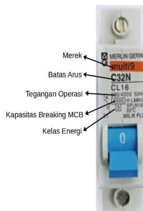
Gambar 3. Kode angka dan huruf pada MCB
