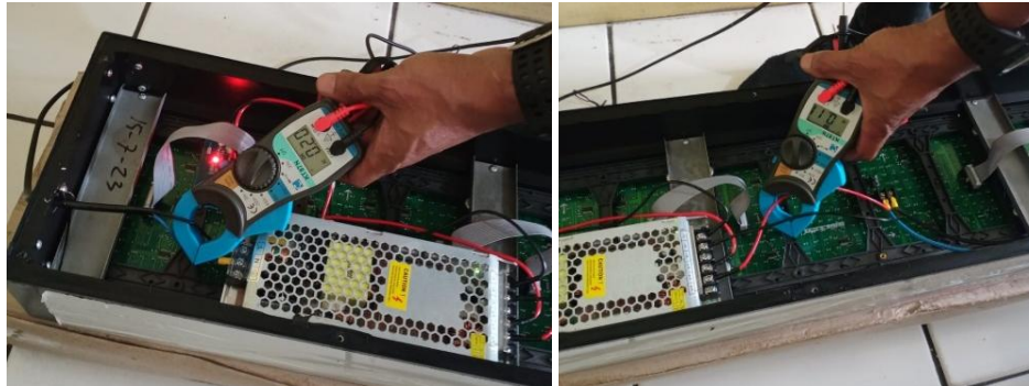
Gambar 7. Pengukuran tegangan dan arus pada rangkaian
